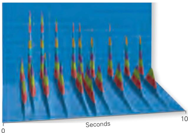
10秒内分离尿嘧啶和苯胺酮类物质：采用100Hz DAD全扫描，流速7mL/min，压力730 bar，柱温100°C，柱子为30×2.1 mm C18，1.5μm 粒径
