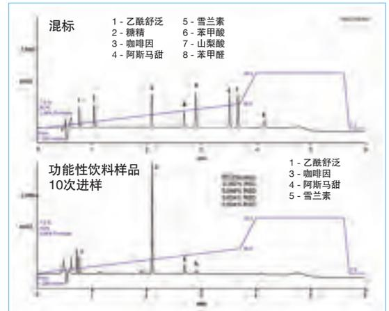
515 bar压力下快速分析软饮料中的添加剂。6分钟内实现混标中所有分析物基线分离。无糖功能性饮料10次连续进样叠加图显示了极佳的保留时间和峰面积精确度。
