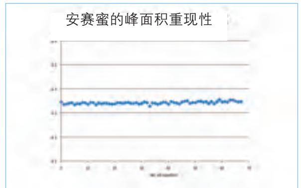
功能性饮料使用UltiMate® 3000基础自动型系统,在超快速液相条件下连续进样68次。并对其中安赛蜜峰面积进行分析。RSD值仅为0.151%,显示出最佳的精度。
