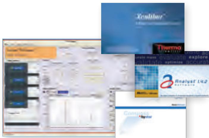
通过DCMS<sup>Link</sup>™ UltiMate® 3000的液相能由质谱软件 Xcalibur™ (Thermo Fisher Scientific), Analyst® (AB Sciex) 和HyStar™ (Bruker Daltonics) 来控制。可在质谱工作站上建立样品序列, 处理质谱数据, 利用DCMS<sup>Link</sup>™控制所有液相模块。最新的软件支持UltiMate® 3000双三元液相的在线除盐、在线固相萃取、二维液相、串联液相、柱后衍生功能。满足质谱前端的所有应用需求。
