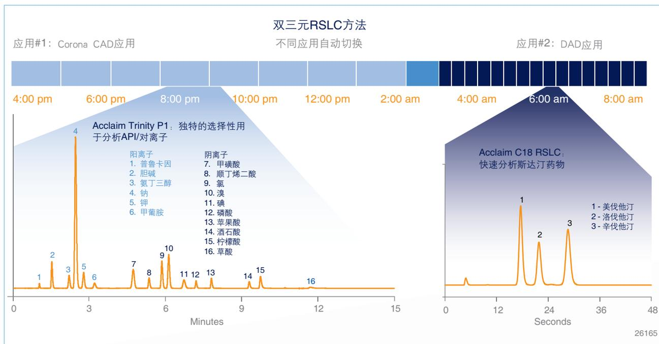
两个应用可整夜或整个周末自动运行。系统自动冲洗色谱柱和管路并切换到另一系统，然后采用新的流动相重新平衡，开始第二个应用。应用可以是标准分析，超快速分析或两种分析间的切换，如上图所示。Corona CAD检测器能同时检测API和对离子，DAD的5μL半分析型检测池可完全适用于各种不同检测方法。
