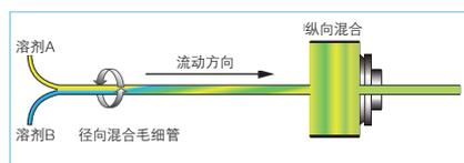
独特的SpinFlow™混合器设计具有卓越的混合性能
